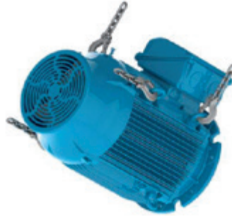
Figura 4.18 - Motor está siendo rotado para hacia la posición horizontal
