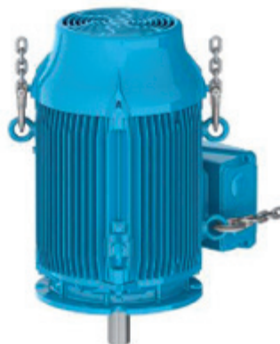
Figura 4.11 - Resultado final: motor posicionado na vertical
