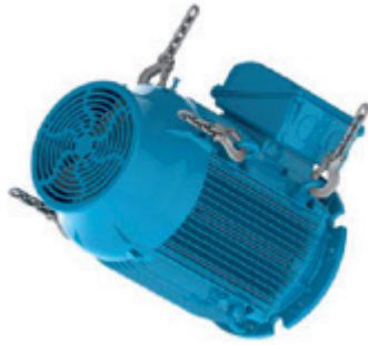
Рисунок 4.18 - Вращение двигателя в горизонтальное положение
