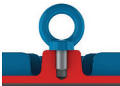
Figura 4.1 - Manera correcta de fijación del cáncamo de elevación
