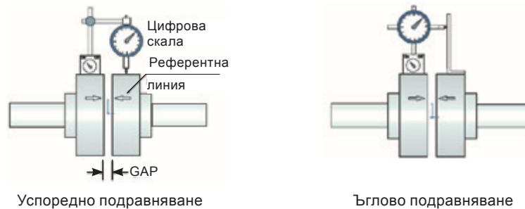
Фигура 6-11 – Подравняване с уреди с цифрова скала
