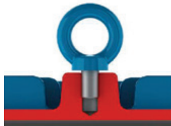
Рисунок 4.2 - Неправильное затягивание рым-болта
