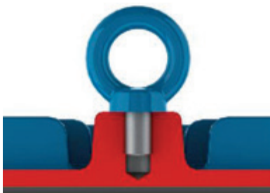
Bild 4.1 - Richtige Befestigung der Transportösen
