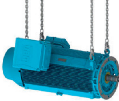
Bild 4.12 - Den Motor der Baureihe HGF und W50 an den vier seitlich angebrachten Transportösen mit zwei Hebevorrichtungen heben
