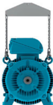
Figura 4.6 - Uso de barra separadora no içamento
