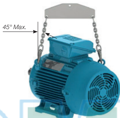
Figurii 4.4 - Unghiul maxim care apare la motoarele cu două sau mai multe șuruburi cu ochi
