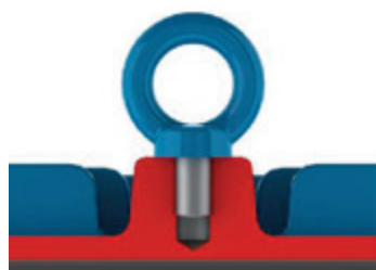
Рисунок 4.1 - Правильное затягивание рым-болта
