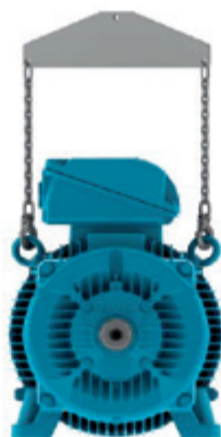
Bild 4.6 - Einsatz eines Querbalkens zum Heben
