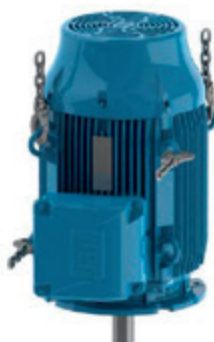
Figura 4.17 - Instalación del segundo par de cáncamos
