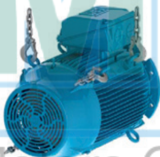
Рисунок 4.10 - Установка второй пары рым-болтов
