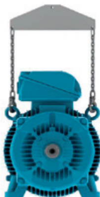
Рисунок 4.6 - Использование распорной траверсы при подъеме
